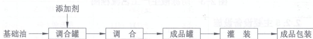
图 2-3 润滑油生产工艺流程图
